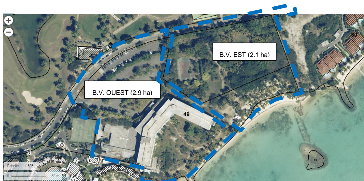
Figure 10 : Cartographie des bassins versants hydrauliques
