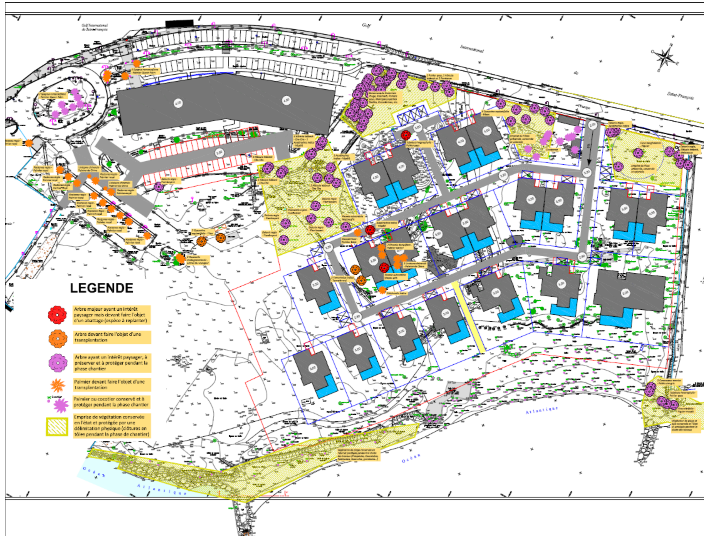
Figure 57 : Présentation des 5 zones préservées (hachuré jaune), des grands arbres d'intérêt préservés (violet), abattus(rouge) ou transplantés (orange)
