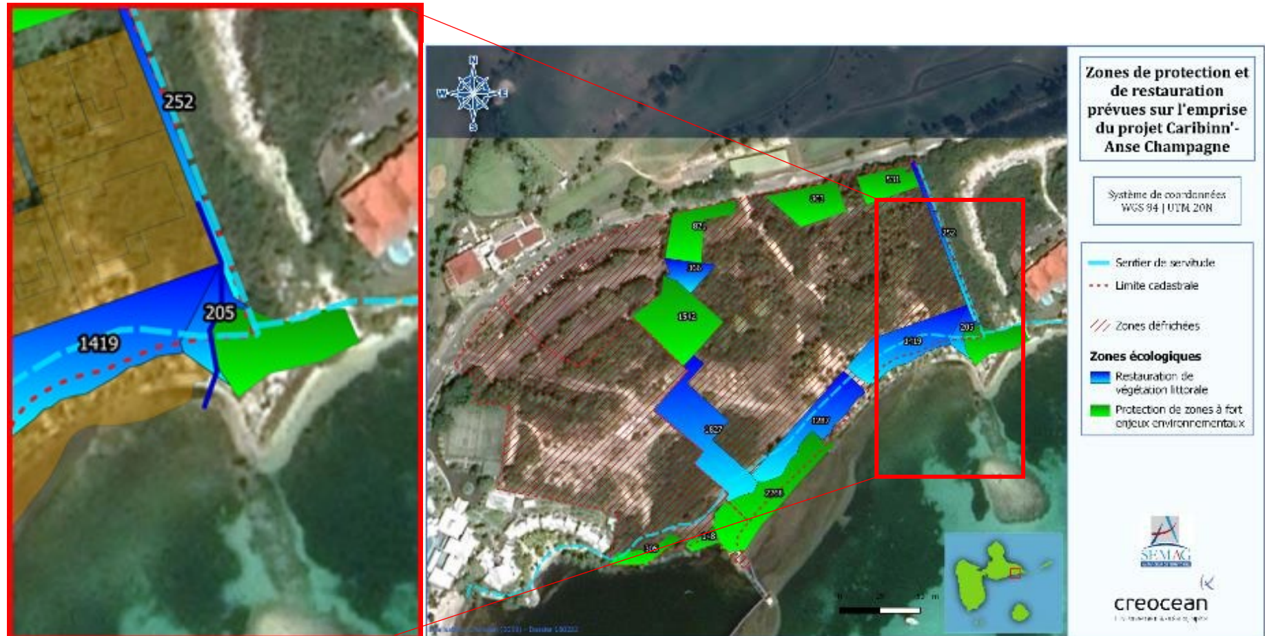
Figure 52 : Zoom sur le tracé de l'émissaire d'eaux pluviales évitant les zones à enjeux forts (vert)
